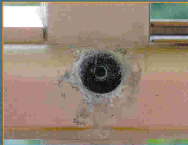
Рис. 5 (внизу). Состояние поверхности алюминиевого (сплав 6063) профиля после 6 лет эксплуатации в атмосфере г. Лидо ди Езоло (Италия).
